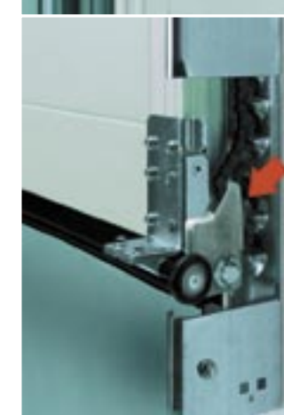
Keliamajame mechanizme esantis fiksuojamas apsaugos mechanizmas sulaukia vartų lakšto lūžus spyruoklei ar trūkus lynui
