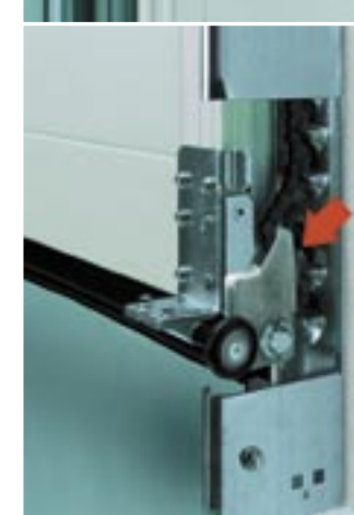
Keliamajame mechanizme esantis fiksuojamas apsaugos mechanizmas sulaukia vartų lakšto lūžus spyruoklei ar trūkus lynui
